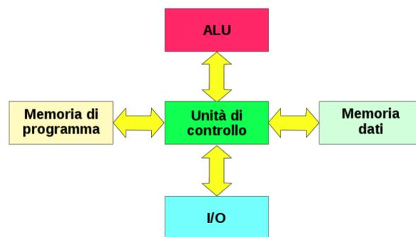
Schema di massima dell'architettura Harvard.
